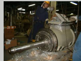
定格主電動機からインバータ電動機に変更
